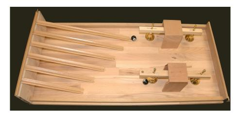
Con l'uso di due coppie di campane si dimostra che le velocità di arrivo delle palline sono tutte uguali, indipendentemente dalla corsia che percorrono.
